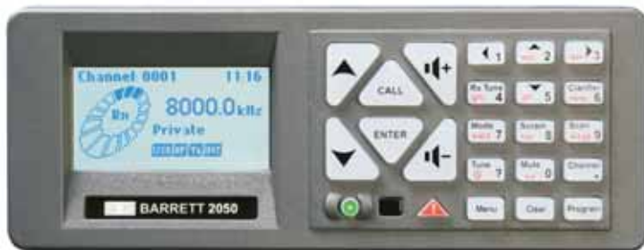
Panel delantero del transceptor de HF 2050 de Barrett punto, y capacidades para inhabilitar el transceptor remoto.
