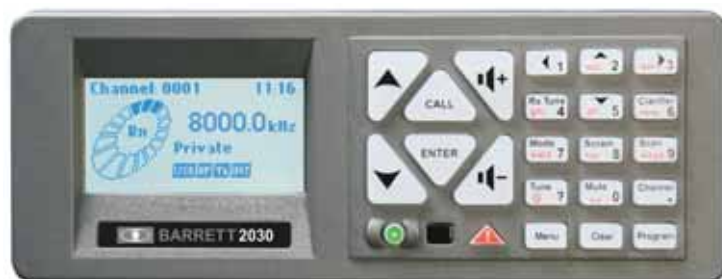
Panneau avant de l'émetteur-récepteur Barrett 2030 HF
