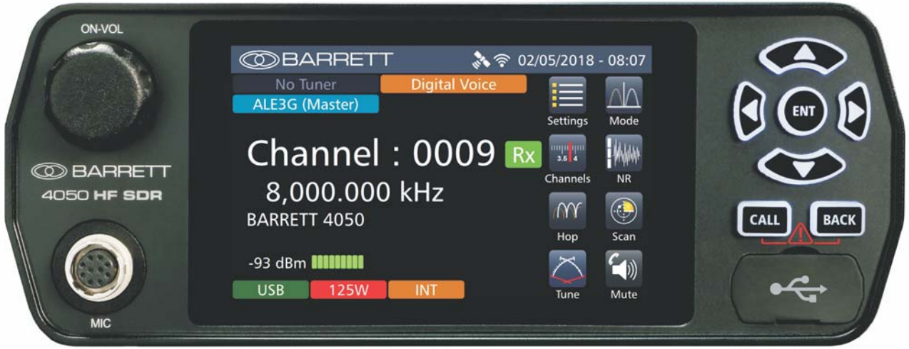
اللوحة الأمامية للجهاز اللاسلكي المُعرَّف برمجياً Barrett 4050 العالي التردد
